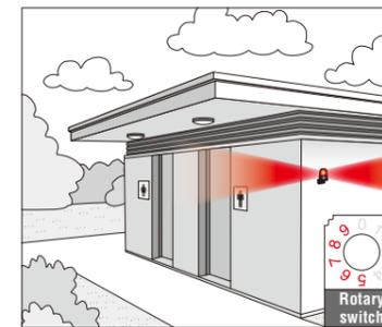
Las señales visuales empezarán a funcionar inmediatamente cuando se encienda la baliza SF. Así se evita tener que disponer de un dispositivo para activar las funciones operativas para este tipo de aplicación.
