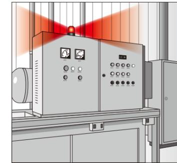
La baliza SL de este panel de control alterna entre luces continuas, parpadeantes y de destello triple para indicar condiciones normales, de advertencia y críticas, respectivamente.
