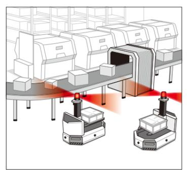
Las balizas SK instaladas en AGV's producen una indicación giratoria y brillante en sus alrededores mientras están en movimiento, para prevenir accidentes en caso de que una persona se cruce en el camino del AGV.
