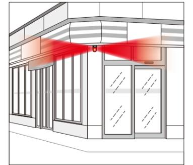
Esta baliza SL colocada en el techo de una tienda indica las emergencias mediante una luz intermitente, que se ve a distancia.
