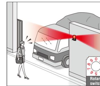
La baliza SF se instala en una entrada para avisar a los peatones del paso de vehículos grandes. Se usa un temporizador para atenuar la luz durante las horas de oscuridad para no cegar a los conductores.
